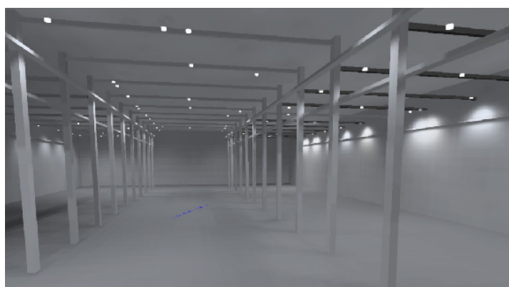
Фиг.2 Светлинен проект на производствено предприятие - снимка разположение на осветителни тела
